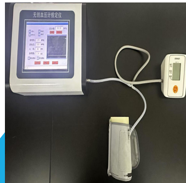
气压系统气密性检查
