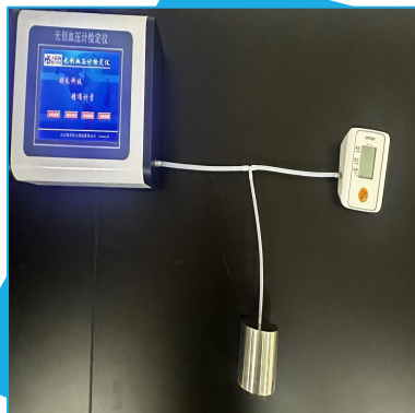
静态压力测量范围及静态压力示值误差的检定
