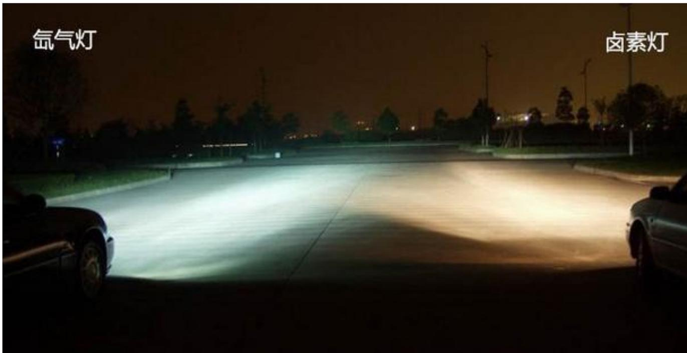
传统头灯使用的卤素灯泡是利用“燃烧式发光”方式产生照明，而氙气灯则是利用“跳电式发光”来照明。前者就像烤肉时，火炭上所发出的光；而后者则类似工厂工地上电焊时所发出的光。根据实验数据显示，氙气灯发光的亮度是传统头灯的三倍，照射距离则为传统头灯的两倍。
