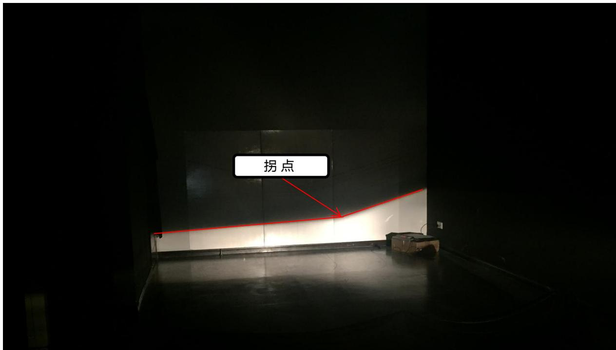
机动车每只前照灯的远光光束发光强度应达到表 8 的要求；并且，同时打开所有前照灯（远光）时，其总的远光光束发光强度应符合 GB 4785 的规定。测试时，电源系统应处于充电状态。
