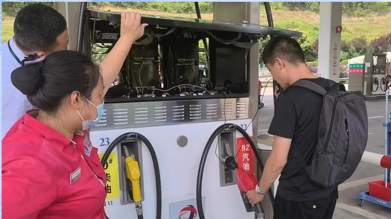
**关键部位8**，在计控主板报税口插入POS机，提起加油枪进入加油状态后，观察POS机是否还能读取税控、计量等相关数据。**如能读取，即存在作弊嫌疑，一定要深挖严查。**
