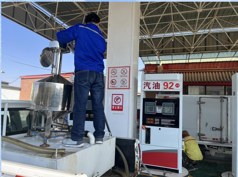
使用标准金属量器对加油枪出油的数量进行检定。不在加油机上设定加油量，拿起加油枪把汽、柴油注入到标准金属量器中，直到标准器液面达到玻璃管内可视高度，对一台加油枪进行检定，看检定结果是否符合检定规程 $\pm 0.30\%$ 要求。
